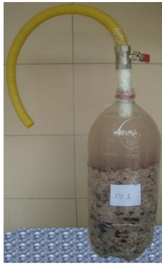
FIGURA 1: Protótipo de biodigestor com garrafa PET.
