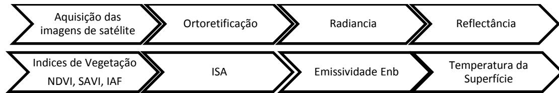
Figura 2. Fluxograma das etapas da obtenção da temperatura da superfície, índices de vegetação e impermeabilidade.
